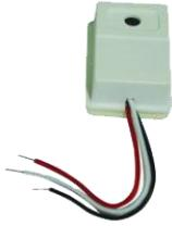
前端采用快鱼 A20 型拾音器，通过音频线接入 BL-6720QPA-EX-L。快鱼 A20 拾音器通过快鱼拾音器专用电源 AMP211 供电。
